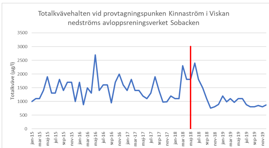
Figur 9: Totalkvävehalten vid provtagningspunkten Kinnaström i Viskan nedströms avloppsreningsverket Sobacken i Borås. Den röda linjen visar när det nya avloppsreningsverket togs i drift (maj 2018). Källa: Sveriges Lantbruksuniversitet, Miljödata.
