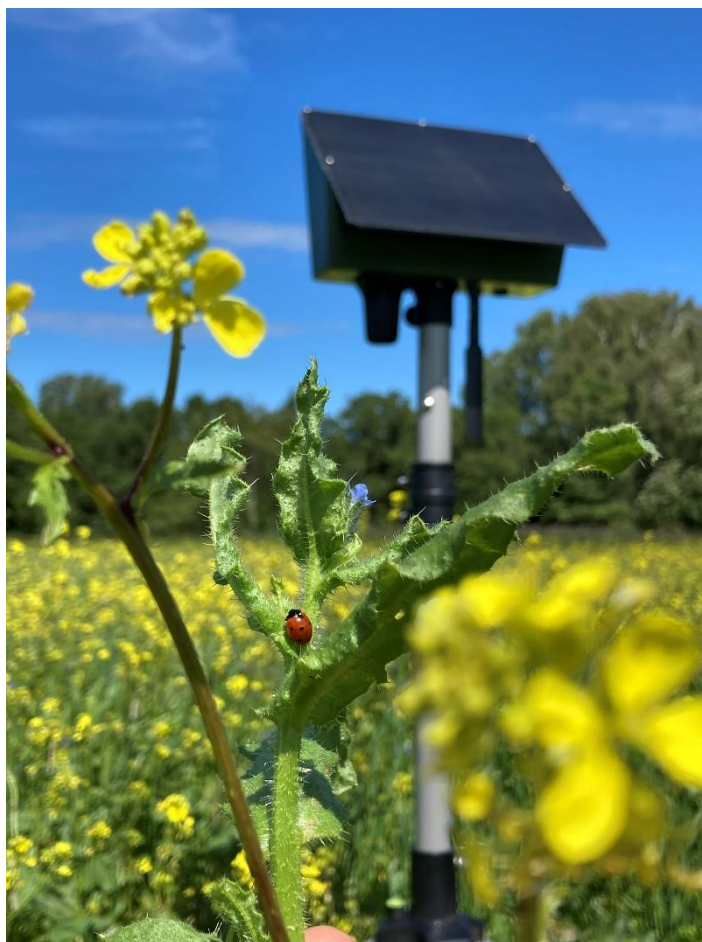
Figur 24. Sensor som mäter förekomst av insekter inom projektet DivGrass. Foto: Anders Stålband
